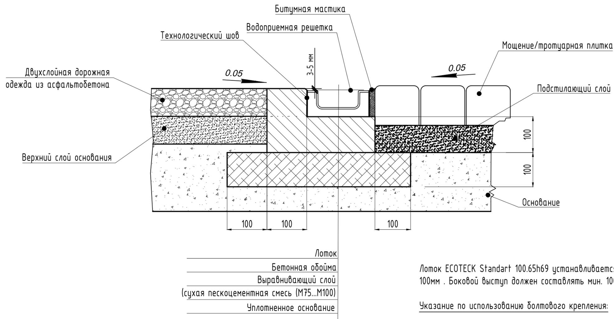
Лоток ECOTECK Standart 100.65h69 устанавливается на бетонное основание с толщиной мин. 100мм. Боковой выступ должен составлять мин. 100мм.
